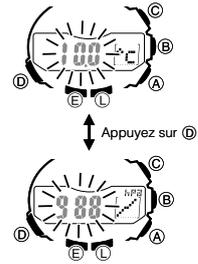
1. Prenez une mesure avec un autre instrument pour déterminer exactement la pression ou la température actuelle.
