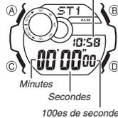
Votre montre présente deux modes Chronomètre : le mode Chronomètre (ST1) et le mode Chronomètre (ST2). Les deux modes Chronomètre permettent de mesurer le temps écoulé, des temps intermédiaires et deux arrivées. Le mode Chronomètre (ST1) inclut le démarrage automatique.
