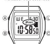
Une diode électroluminescente (LED) et un panneau à guide lumineux éclairent tout l'afficheur, qui de ce fait est parfaitement visible dans l'obscurité.
